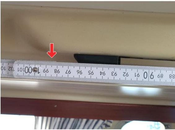
Die neue Schiene kann in einer Länge von 985 mm montiert werden.
