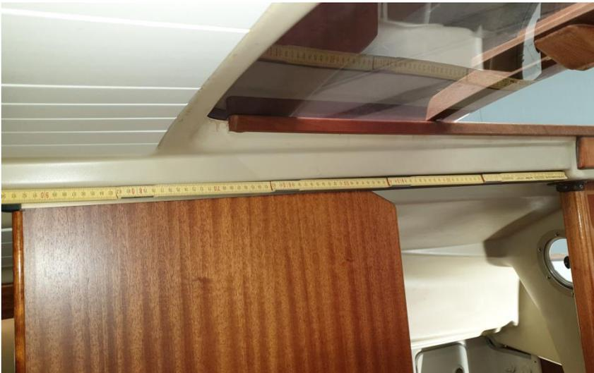
Die Tür mit einer Breite von 530 mm mit innenliegendem Griff lässt eine Öffnungs-Breite von max. 420 mm zu
