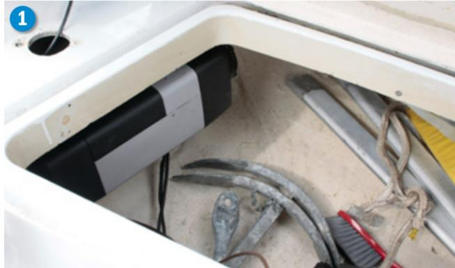
1) Zuerst stellt sich die Frage, wo das Heizgerät montiert werden soll. Wichtig dabei: Woher kommt die Frischluft für die Verbrennung, die Luft für das Gebläse und wohin werden die Abgase der Heizung nach außerbords geführt? Ein guter Platz dafür ist in der Regel eine Backskiste mit guter Belüftung.
