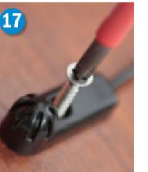
17) Zum Schluss werden im Boot der Temperaturfühler für den Thermostat und das Bedienelement (18) montiert und mit dem zur Heizung gehörenden Kabelbaum verbunden.
