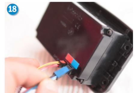
18) Die am Kabelbaum vorhandenen Flachsicherungen sollten nicht über einen Schalter, sondern direkt mit dem Batterie-Hauptschalter verbunden werden. Ein versehentliches Abschalten der Heizung kann sonst zu einer Störung führen, wenn das Heizgerät nicht zur Kühlung nachlaufen kann. Anschließend kann der Testlauf beginnen.
