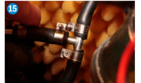
15) Bei einer Dieselheizung lohnt es sich, den Kraftstoff direkt aus dem Haupttank zu entnehmen. Dazu wird am besten ein eigener Tankentnehmer an den Tank angebracht. Geht dies nicht, kann auch mit einem T-Stück Kraftstoff an der Motorzuleitung abgezweigt werden. Das T-Stück vom Tank aus vor der Kraftstoffpumpe des Motors anschließen!
