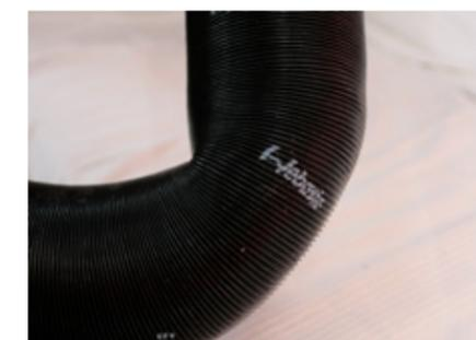
Dellen und Knicke im Schlauch führen schnell zu einem Rückstau und sind daher zu vermeiden
