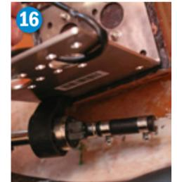
16) Die Heizung hat eine eigene Kraftstoffpumpe, die nahe der Heizung angebracht wird und über einen eigenen Kraftstofffilter geschützt sein sollte.
