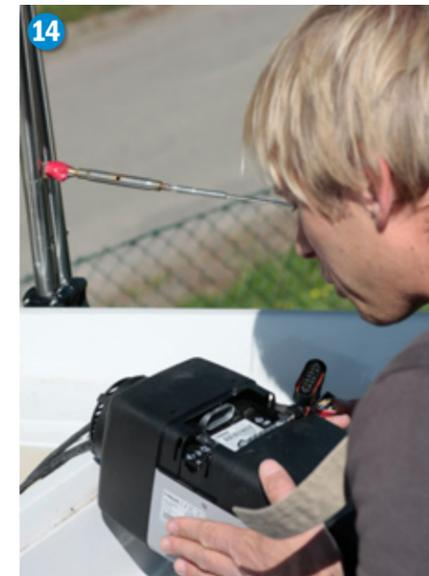
14) In der Zwischenzeit ist der anlamierte Heizungshalter ausgehärtet, so dass die Heizung an ihren Platz kommen kann. Vorher muss jedoch der Kabelbaum abgeschlossen werden.
