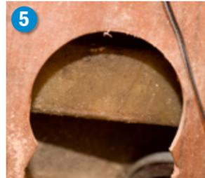
5) Vorsicht bei Schottdurchbrüchen: Bootsbausperrholz ist hart und produziert sehr feine Späne, die beim Sägen schnell heiß werden. Dicke Platten daher in mehreren Etappen bohren und zwischendurch etwas abkühlen lassen. Keinesfalls Bodenwrangen oder ähnliche Strukturelemente zerstören. Tauchen diese hinter Verkleidungen unerwartet auf, muss ein anderer Weg für das Heizrohr genommen werden.
