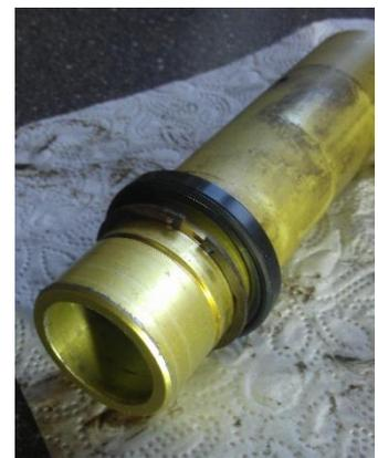
13. Reinigen, die Bohrungen für die Schmiernippel schneiden und in der richtigen Reihenfolge wieder zusammenbauen:
